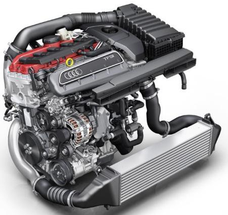
直列5気筒エンジンは、全長が49cmと非常にコンパクトな設計になっています。重量は約180kgです。シリンダーブロックは、きわめて強度が高くそのぶん軽いバーミキュラー鉄でできており、的確な場所に補強を施すことで、高い負荷を受け止められる設計にしています。この2.5 TFSIの製造は、ハンガリーのジュールにあるAudiのエンジン工場で、特別に訓練された専門職員のチームにより、ひとつひとつ丹念な手作業により行われています。
