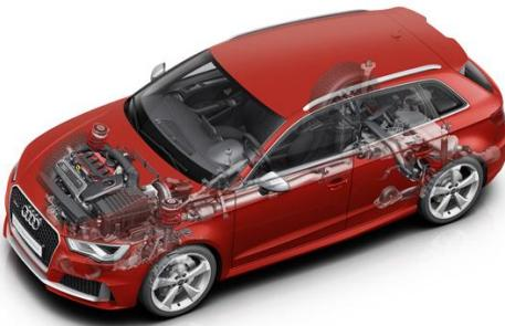
標準装備のホイールは 5 アームローター デザインの 19 インチ鋳造アルミ製で、235/35 サイズのタイヤと組み合わされています。そのほかオプションで、5 アームローター デザインのマットチタン風ポリッシュ仕上げの 19 インチタイプも選ぶことができます。さらに、オプションの自動可変ダンパーシステム、アウディ マグネティックライドを装着すれば、Audi ドライブセレクトのモード選択（コンフォート、オート、ダイナミック、インディビデュアル）に対応して 4 輪それぞれのダンパー減衰力がアクティブに制御され、さらに乗り心地と運動性能が向上します。
