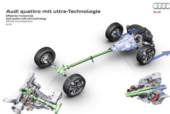
Audi quattro with ultra technology のドライブ機構。フロントのトランスミッション出力軸にマルチプレートクラッチが、リヤのディファレンシャル内にもデカップリングクラッチが設置されていて、4WD での走行が必要とされない場合には、両方のクラッチを遮断して、駆動抵抗を最小化します
