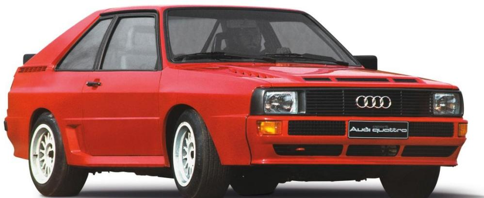
Audi Sport quattro は、WRC グループ B のホモロゲーションを取得するために 214 台が生産されました。エンジン排気量は、過給エンジンのレギュレーションに合わせるため、Ur- quattro よりやや小さい 2,133cc の DOHC 20 バルブで、最高出力 306hp/6,500rpm、最大トルク 35.7kgm/4, 500rpm を発生しました。ボディのアウトパネルの多くは樹脂とケブラー繊維の複合材で、ホイールもフェンダーも幅が広く、フロントガラスは高い視認性を求めるアウディスポーツラリーチームのドライバーの要望に沿って Ur- quattro より傾斜が立ち上がっています。ホイールベースは Ur- quattro より 320mm 短く、回頭性に優れています。
