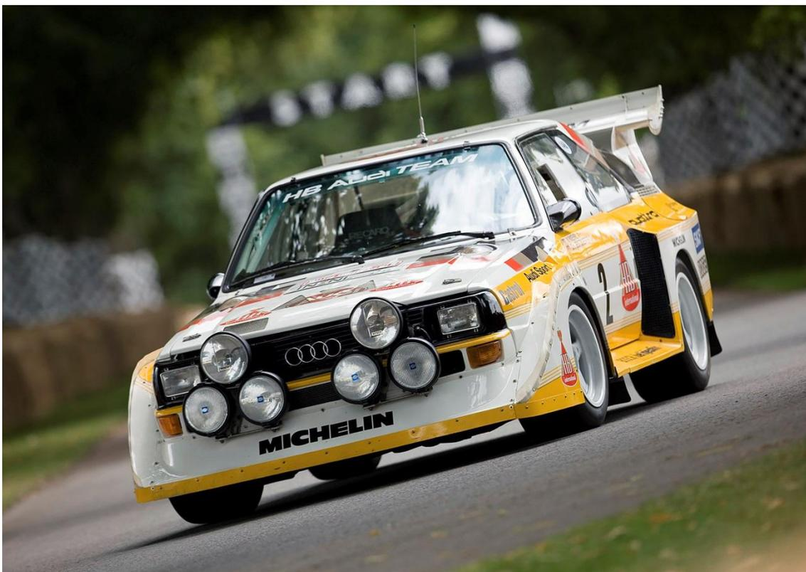
1981 年の登場以来、1983 年まで WRC で圧倒的な強さを見せた Audi quattro ですが、1984 年になるとライバルメーカーは当時の WRC グループ B のレギュレーションの許容範囲内で、ミッドシップのレイアウトを含めた、まったく新しい設計のモデルを投入するようになりました。それに伴いアウディも 1984 年シーズン途中に、ホイールベースを縮めてハンドリングの敏捷性を高めた Audi Sport quattro を投入します。そして翌 1985 年シーズンには、5 気筒エンジンのパワーを 360kW (476ps) まで高めた Audi Sport quattro S1 を参戦させました。
