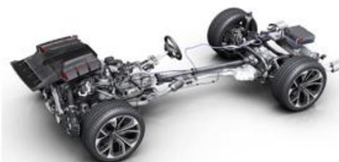
このアプローチは、お客様にとって多くのメリットがあります。回生されたエネルギーは、動力性能向上のために活用することができます。内燃エンジンと電気モーターが同時に働くブーストモードにおいては、電気モーターにより 20kW のパワーと 170Nm のトルクが加算され、V6 エンジンのパワーと併せて、合計 350kW のシステムパワーと 700Nm のシステムトルクが得られます。それにより Audi Q8 sport concept は、どんな走行速度、どんなエンジン回転域からでも、スポーティな瞬発力を発揮することができます。
