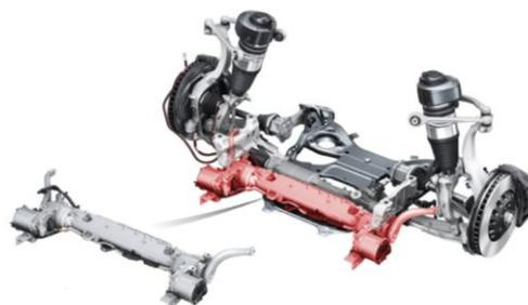
のシステムの助けも借りて、素早い反応で衝撃を受ける側のボディを持ち上げて、乗員へのダメージを緩和します。この革新的なサスペンションシステムも、作動するためのエネルギーを 48 ボルト電源から得ており、アウディは 48 ボルトのシステムを、新型 Audi A8 のすべてのモデルに、メイン電源として初採用しています。新型 Audi A8 用に特別にリファインされたエアサスペンションとともに、Audi AI アクティブサスペンションは、かつてないドライビング体験の創出に貢献しています。
