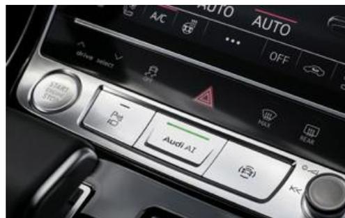
Audi AI リモートパーキングパイロットと Audi AI リモートガレージパイロットは、クルマを自律的に (ドライバーなしで) 操作して、パーキングスペースもしくはガレージに導いてくれるとともに、そこからの脱出も自動操作で行うシステムです。操作の実行は、新開発の myAudi アプリを使って手持ちのスマートフォンから行います。パーキング操作を継続するには、Audi AI ボタンを押し続けなければなりません。そのとき myAudi のアプリに、車載の 360° カメラからの映像が映し出されます。操作が完了すると、ティプトロニックが自動的に P のポジションに入り、エンジンとイグニッションがスイッチオフされます。ドライバーがクルマから降りずに運転席に座ったままの場合には、センターコンソールにある AI ボタンを使って、Audi AI パーキングパイロットを作動させることも可能です。
