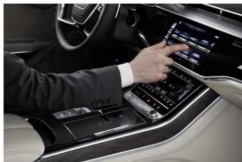
クルマのドアを開けると、ユーザーインターフェースがすぐさま立ち上がります。ドライバーは、大型ディスプレイに指で触れることで、インフォテインメントシステムの操作を行います。センタートンネルコンソールにある 2 番目のタッチスクリーンは、エアコンディショニングと快適機能にアクセスするためのもので、同時にここからテキストの入力も行います。そのとき、ティプトロニックの幅広いレバーの上に手首を乗せたまま、例えば、検索のための文字入力ができるなど、快適にタッチスクリーンの操作を進めることができます。2つのディスプレイのうちどちらかが稼働したときには、チャイムとクリック感で、そのことがドライバーに伝えられます。ガラス調の操作ボタンも同様の反応を示します。音と触感によるフィードバックを組み合わせて、新しい「MMI タッチレスポンス」は、非常に安全で、直感的に行えて、さらに素早い操作が可能になっています。
