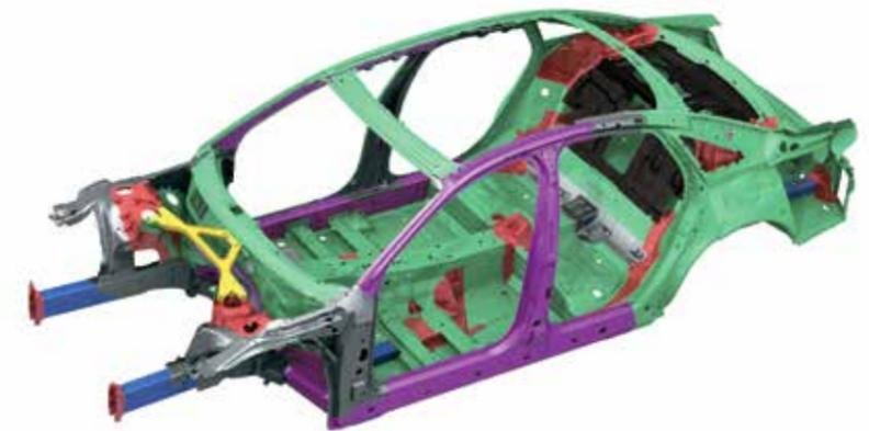
イドシル後端からホイールハウス周辺までつながっているフレーム部分)に使用されています。性能のうえでは一体成型とすることが望ましいのですが、長く、非常に複雑な形状のためにスチール材では製造が難しいパーツでした。エンジンルーム内のストラットブレースはマグネシウム合金製で重量を28%削減、それをストラット頂部に取り付けるボルトはアルミニウム製です。
