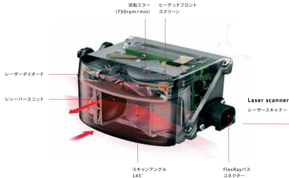
回転するミラーのフォトダイオードで検知して、周辺の物体と形状を正確に探知し、3次元の環境認識を可能にするシステムです。LiDARとも呼ばれるこの技術は、雲やエアロゾルなどの大気観測や上空からの地層の観測などでも知られており、高度な自動運転の実現には欠かせない技術です。かつては非常に高価だったこのセンサーを、アウディは市販モデルに初めて採用しました。新型A8のレーザースキャナーは、80m離れた場所までカバーし、その範囲内であれば、たとえ夜間であってもスキャナーは対象物の形状を正確にとらえることができます。
