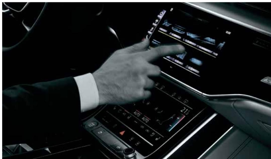
のフィードバックとして指に振動が伝わります。この振動は、スプリングを介してマウントされたスクリーンを、電磁力で髪の毛の太さほどのわずかの幅を動かすことで生み出されます。同時に小さなスピーカーからクリック音が聞こえます。フィードバックの振動は、3段階に調節が可能で、振動オフを選択することもできます。このシステムによってアウディは、ユーザーエクスペリエンスの新たな地平を切り拓きました。
