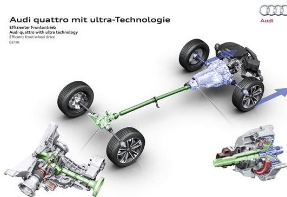
Audi quattro with ultra technology のドライブ機構。フロントのトランスミッション出力軸にマルチプレートクラッチが、リヤのディファレンシャル内にもデカップリングクラッチが設置されていて、4WD での走行が必要とされない場合には、両方のクラッチを遮断して、駆動抵抗を最小化します
