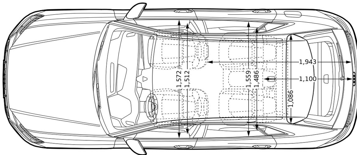
\*1 S line/パッケージ装着車の場合+10mm \*2 ラグジュアリーパッケージ装着車の場合 フロント 1,685mm/リヤ1,695mm \*3 アダプティブエアサスペンション装着車の場合 1,690mm ※単位 : mm イラストは欧州仕様車となります。車両は日本仕様とは異なります。
