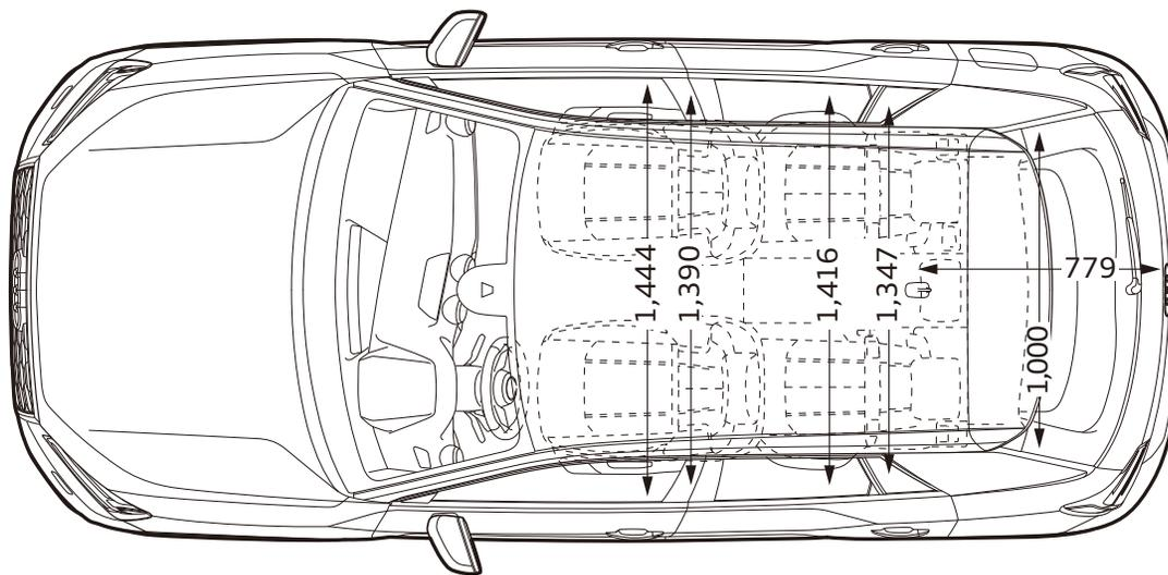
\*1 S line装着車の場合+5mmとなります。 \*2 S line装着車の場合-10mmとなります。 \*3 MMIナビゲーションシステム装着車の場合+30mmとなります。 ※単位：mm イラストは欧州仕様車となります。車両は日本仕様とは異なります。
