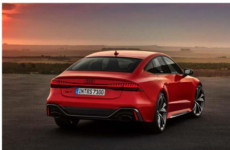
リアエンドでは、滑らかなラインを描くスポイラーリップと、左右のリアライトを繋ぐライトストリップが、Audi RS 7 Sportback の大きな特徴となっています。速度が 130km/h を超えると、テールゲートからスポイラーが展開します。RS エキゾーストシステムの大径楕円テールパイプは、クロームカラーを纏い、リアディフューザーとともに RS 専用バンパーの左右に配置されています。
