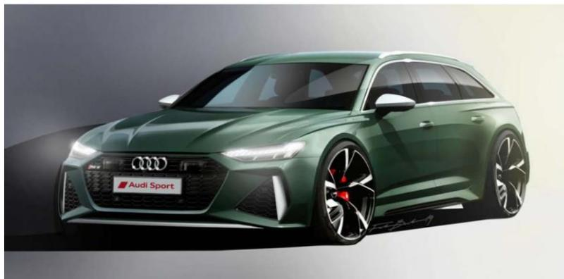
RS 6 Avant は、パワーバルジを備えた新しいボンネットに加え、A7 と同様のフロントヘッドライトも採用しています。これにより、よりフラットでスポーティなスタイルが生み出されています。標準装備のダークベゼルを備えたレーザーハイビーム付きマトリクス LED ヘッドライトは、RS 6 Avant の新しいセールスポイントとなっています。
