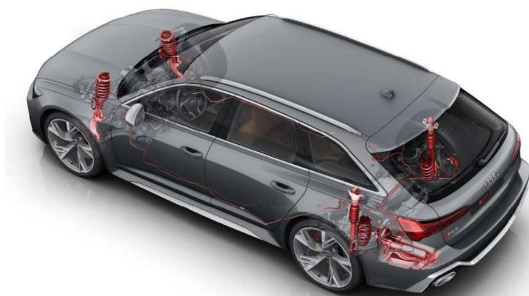
新しいダンパーは、バルブが統合されて、よりコンパクトなデザインを採用したことにより軽量化され、ピッチングやローリングをさらに効果的に低減します。また、以前のシステムと比較して、コンフォートとダイナミックモード間の設定幅が広がるとともに、高い減衰力が発生する状況で、より正確にサスペンションの特性を調整できるようになりました。これは、とくに高速コーナリング時に実感することができます。その結果、ダイナミックライドコントロール（DRC）付き RS スポーツサスペンションでコンフォートモードを選択すると、驚くほど良好な乗り心地を体験することができます。その一方で、ダイナミックモードを選択すると、コーナーをハイスピードで攻めた場合でも、卓越したドライビング精度を提供します。ドライバーは、オーディオライブセレクトを操作して、ダンパーの反応を変更することで、ダンパー特性、つまりドライビング体験をカスタマイズすることが可能です。
