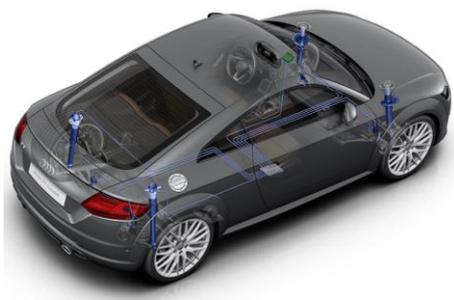
システムであり、日常的にはどのモードを選択しても、乗り心地、操縦性の面で優位性を感じることが出来ます。サーキットを走る場合は、dynamic のモードを選択して、高められたダンパーセッティングにより、ロールやピッチングを抑制した走りを楽しむことが推奨されます。
