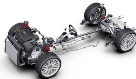
前後のトルク配分を制御する電動油圧式の多板クラッチユニットは、プロペラシャフトの後端、リヤディファレンシャルの直前に搭載されており、従来型のものより重量が 1.5kg 軽くなって、制御ソフトウェアも、新型 TT 専用のものが搭載されています。その専用のソフトウェアにより、quattro フルタイム 4 輪駆動システムがアウディドライブセレクトのシステムと、今回初めて統合されることになりました。ここでは、ステアリングアングルなど運動性能に関わるデータが、quattro システム制御の判断材料に加えられます。例えば、高い速度のままコーナーに侵入したとき、ドライバーがステアリングを切った瞬間から駆動力の一部がリアアクスルに送られるようになって、その後ドライバーがアクセルペダルを踏み込んでも、クルマはアンダーステアを誘発することなくスムーズにコーナーを曲がっていきます。高いトラクションが求められる状況下では、中央の多板クラッチユニットは前後方向のデフロック機構として働き、それに対して ESP システムに内蔵されたトルクベンダリングの機能が、横方向のデフロック機構としての役割を果たします。
