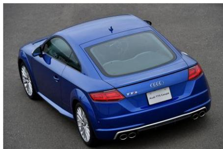
ヘッドライトの内側のラインが A ピラーの根元にまで延びて、ボンネット上にシャープな V ラインを表現しています。フロントのホイールハウスにまでかかったボンネットのオープニングラインは、そのままサイドドア上のキャラクターラインにつながって、そのラインがリヤフェンダーを経て、サイドまで回り込んだテールライトのエッジまで延びています。また、テールライト上端を結ぶラインの上側には、空力的な効果を備えた小さなリップが設けられており、リヤゲートの部分ではそこが速度に応じて自動的に上下するリトラクタブルリヤスポイラーになっています。ボディの空気抵抗を表す Cd 値は、S line エクステリア パッケージ装着モデルで 0.29 という、このクラスのスポーツカーではベストの値が記録されています。
