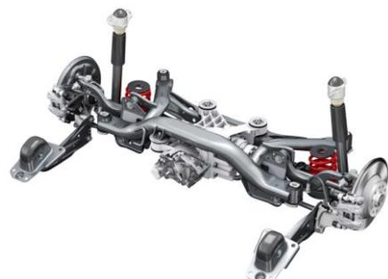
車両の軽量化及びバネ下重量を減らして乗り心地を改善するために、サスペンションシステムには多くのアルミ部品を使っています。フロントではサブフレームとピボットベアリングが、リヤでもハブキャリアがアルミ製となっています。
