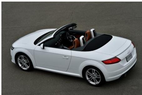
Coupe モデル同様に、今回多くの点で設計が刷新された 2.0 TFSI は、従来型よりも 19PS、20Nm アップした 230PS、370Nm のパワー、トルクを発揮します。その一方で燃費効率は 14.4km/l と、従来型の 13.0km/l から 11 パーセントの改善を果たしています。燃費消費削減のためにスタートストップシステム／エネルギーリカバリーシステム、6 速 S トロニックのフリーホイール機構などを採用している点は、Audi TT Coupe と同様です。
