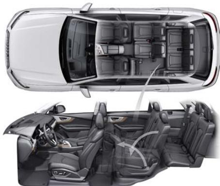
オプションの7シーターパッケージで選択できる独立式の3列目シートは、欧州で「グループ3」規格のチャイルドシートとして認められています。従来型の場合と比べて、ヘッドルームが24mm、ショルダールームも22mm広くなっています。シートを折り畳んだときはシートバックがラゲージフロアと面一になって、Cピラーとラゲージコンパートメントに設置されたロックアースイッチを使って、電動パワーによりその高さを調整することができます。
