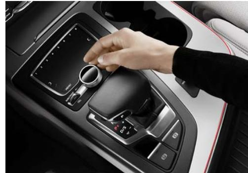
ここでとくに注目に値するのは、新開発の大型タッチパッドを備えた MMI のコントロールユニットです。入力にはすべて音と指に伝わるクリック感によるフィードバックが伴い、ドライバーはこのタッチパッドを介して、指で文字入力したり、2 本の指を使って地図画面のズームイン／アウトを行ったり、リストをスクロールしたりできます。主要な機能へのアクセスは、高精度のロータリープッシュボタンと 2 つのスイッチを使って行う一方で、自由にプリセットできる 8 つのボタンを活用して、設定頻度の高いナビゲーションの目的地や電話番号、ラジオ局など、お好み情報へのアクセスを簡便に行なうことができます。
