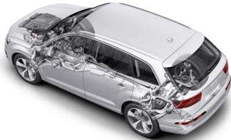
性能の実現をサポートします。通常時は、このセンターディファレンシャルにより、駆動力はフロント 40 対リヤ 60 の割合で分配されますが、どこか 1 輪がグリップを失った場合には、瞬時の判断により、フロントに最大 70 パーセント、リヤに最大 85 パーセントの割合で、分配率を調整します。また、このメカニカルセンターディファレンシャルは、電子的なディファレンシャルロック機構である「トルクベクタリング」と機能的に密接な連携が図られており、高速コーナリングでは中央のソフトウェアのプログラムにより、負荷が比較的少ないカーブの内側にあたるホイールに軽くブレーキによる介入を行います。それにより、ステアリングレスポンスがより俊敏で正確なものとなり、タイヤのグリップ力もフルに発揮されるようになります。
