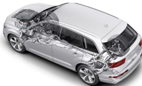
性能の実現をサポートします。通常時は、このセンターディファレンシャルにより、駆動力はフロント 40 対リア 60 の割合で分配されますが、どこか 1 輪がグリップを失った場合には、瞬時の判断により、フロントに最大 70 パーセント、リアに最大 85 パーセントの割合で、分配率を調整します。また、このメカニカルセンターディファレンシャルは、電子的なディファレンシャルロック機構である「トルクベクタリング」と機能的に密接な連携が図られており、高速コーナリングでは中央のソフトウェアのプログラムにより、負荷が比較的少ないカーブの内側にあたるホイールに軽くブレーキによる介入を行います。それにより、ステアリングレスポンスがより俊敏で正確なものとなり、タイヤのグリップ力もフルに発揮されるようになります。
